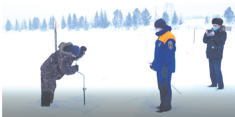
Перед открытием ледовой переправы специалисты проверили толщину льда. Она соответствует нормативным требованиям.
